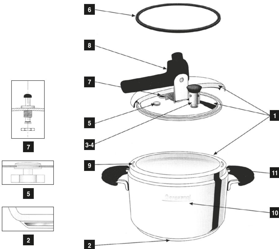
**1** Corpo, coperchio e traversa: acciaio inox 18/10 (AISI304).
