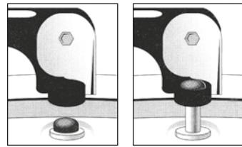
**Il dispositivo di bloccaggio leva ha due funzioni di sicurezza: segnala la presenza di pressione all'interno della pentola ed impedisce l'apertura accidentale del coperchio durante la cottura.**
